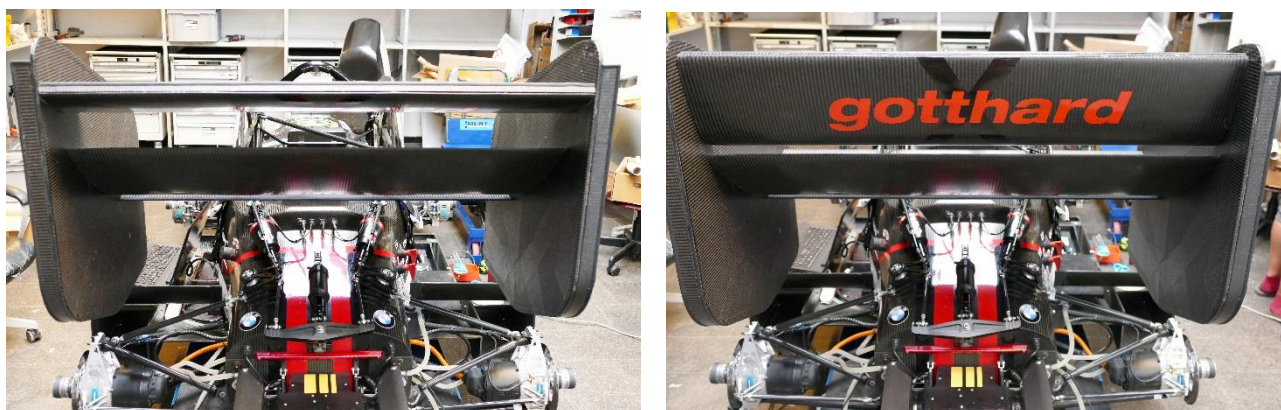
電動車的尾翼藉助一組 maxon motor 驅動系統來進行升降調節。© 2016 AMZ Racing Team
